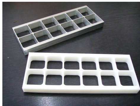
Element formujący wkładki cukiernicze z cienkich folii
